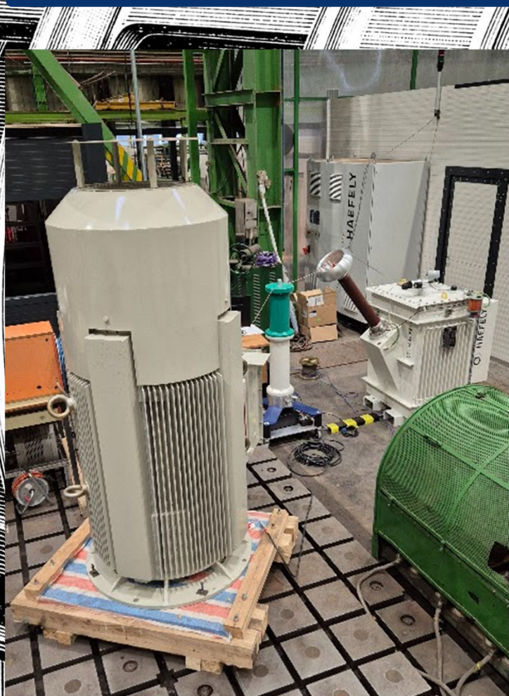
Üszigetelt motor, UST-módban mérve tekerccs eleje – vége összekötve és an
