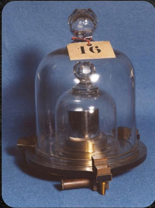
16-os számú kilogramm etalon platina-irídium henger A tömeg nemzeti etalonja
