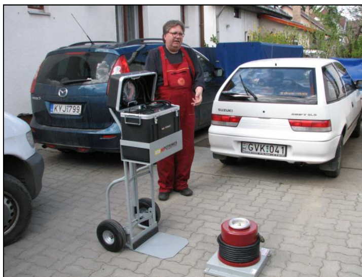
100HVT 0...100kV 50mA 0...50kV 100mA 50Hz Kézi vezérlés, hordozható kivitel
