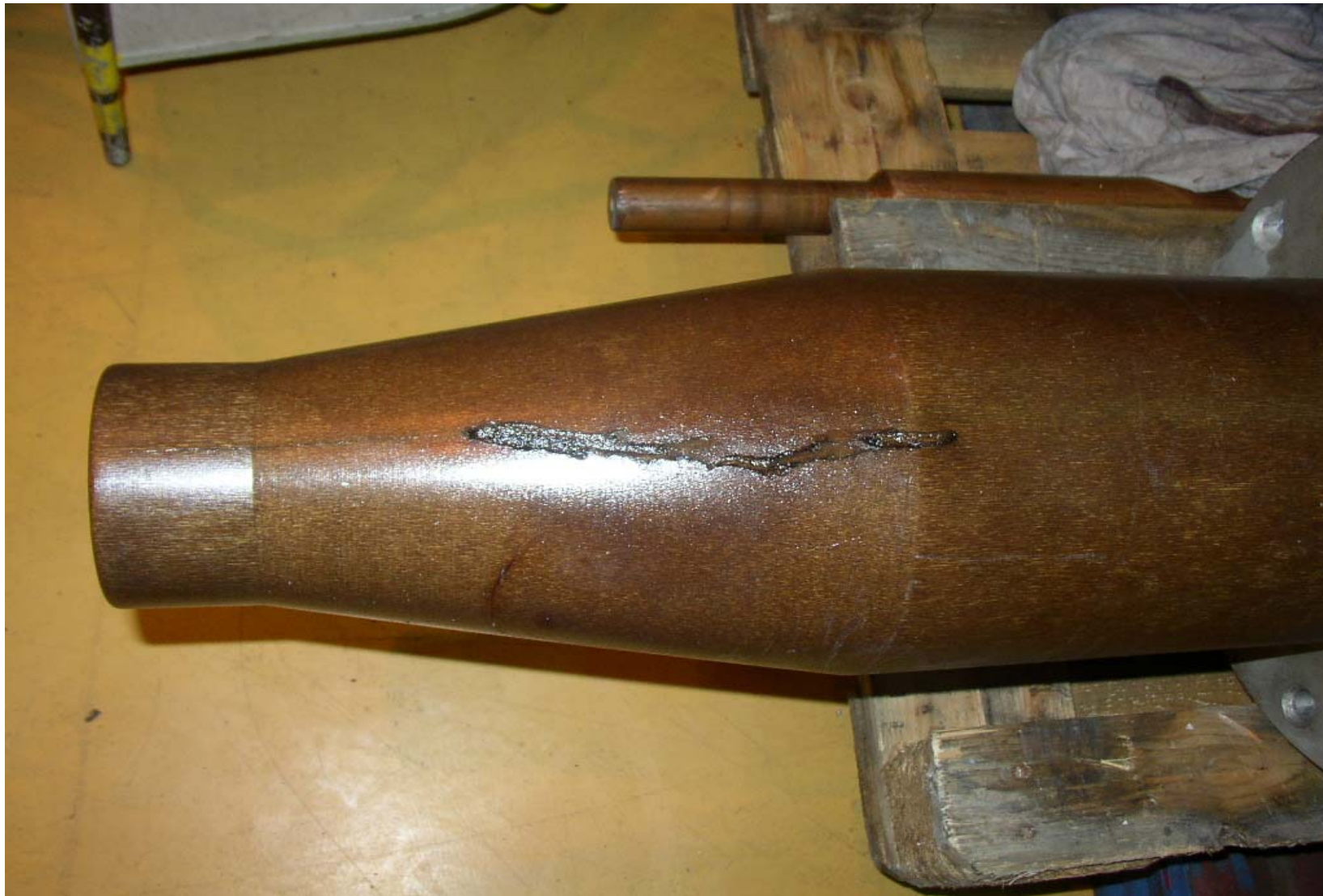
4. sz. trafó 120 kV-os átvezető (F&G ESKTFK 650/145)
