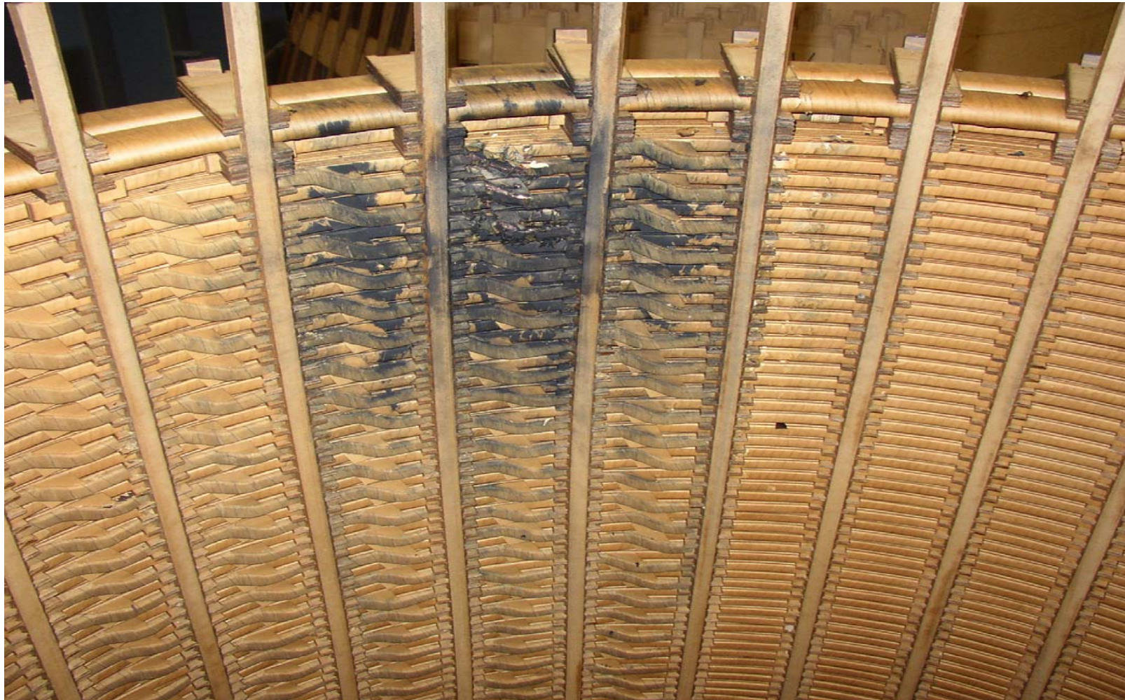
1.tr. Gyári javítás: sérült 120 kV-os tekercs
