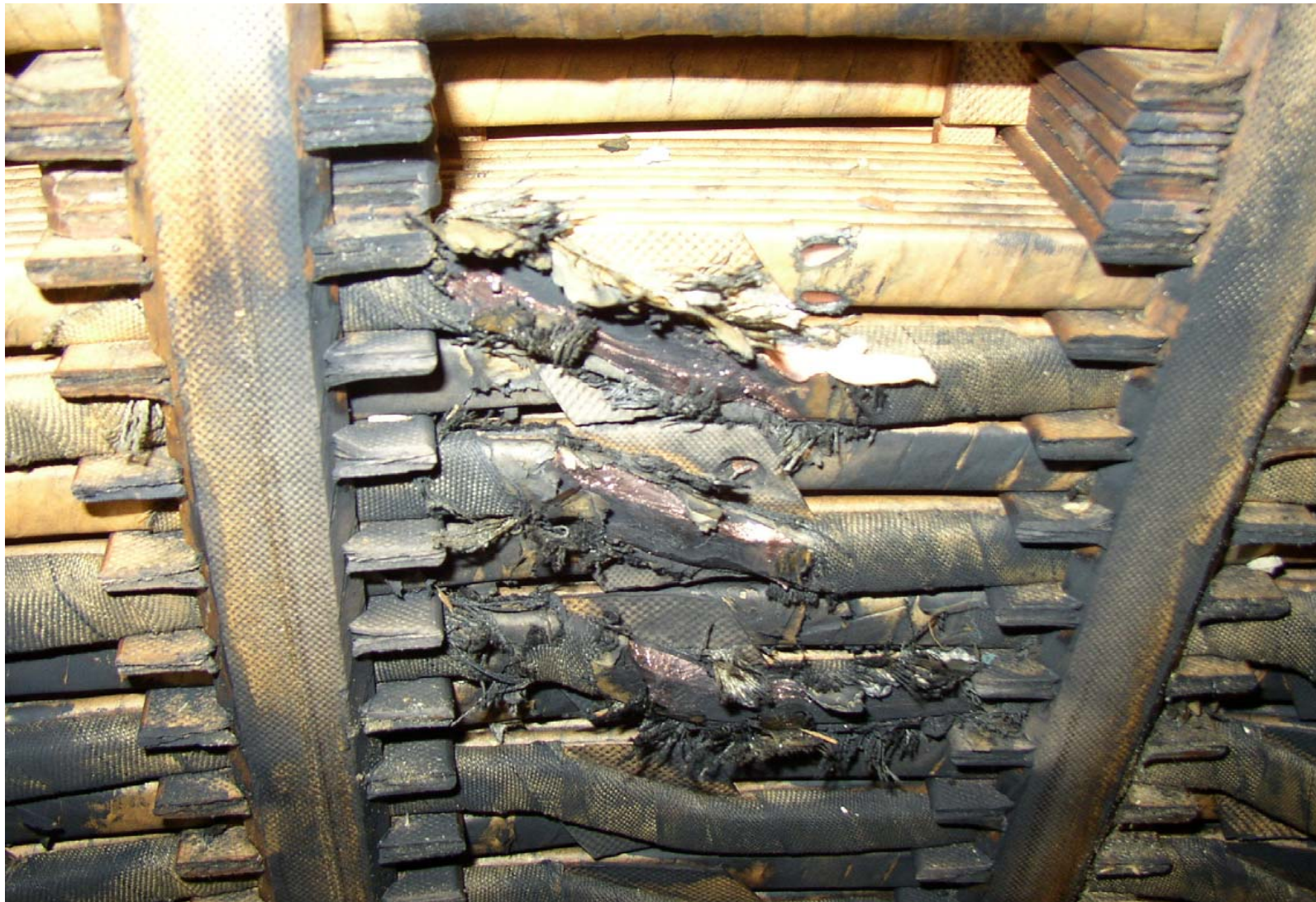
1.tr. Gyári javítás: sérült 120 kV-os tekercs
