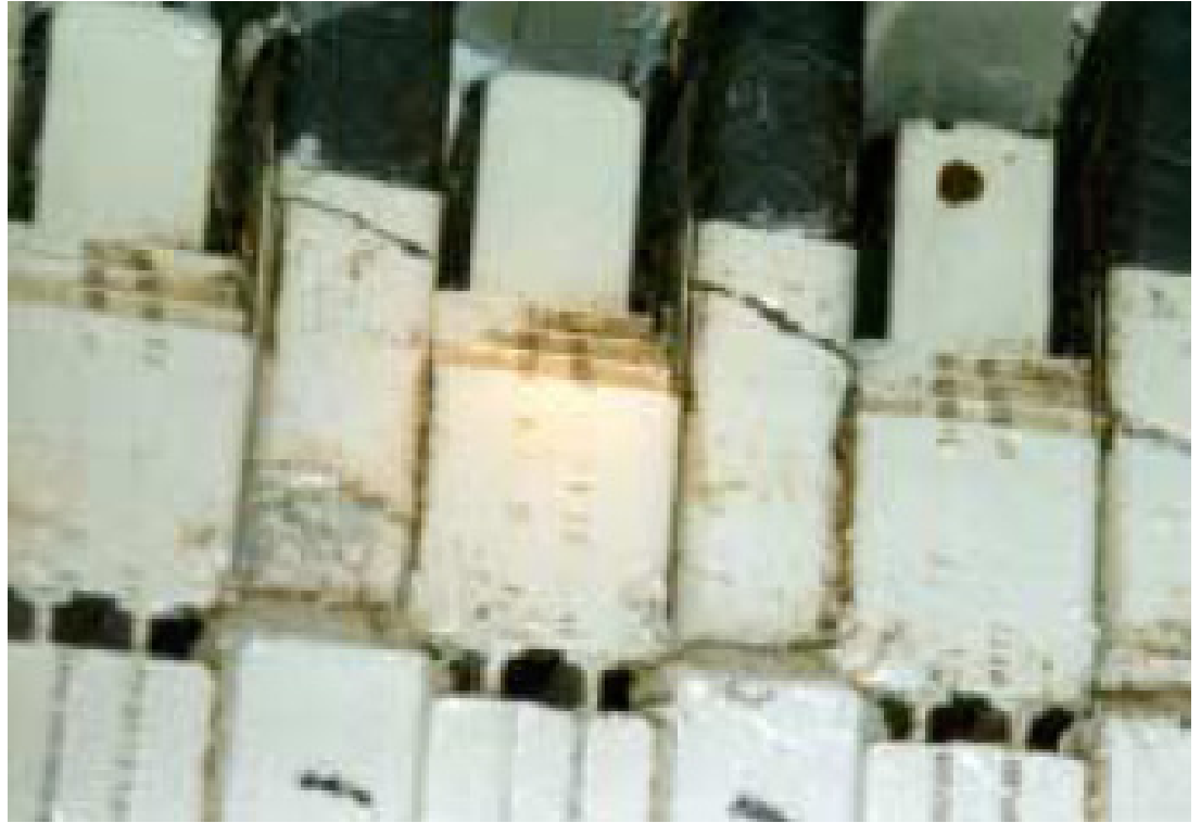
Rövidzárlati erő miatti törés
