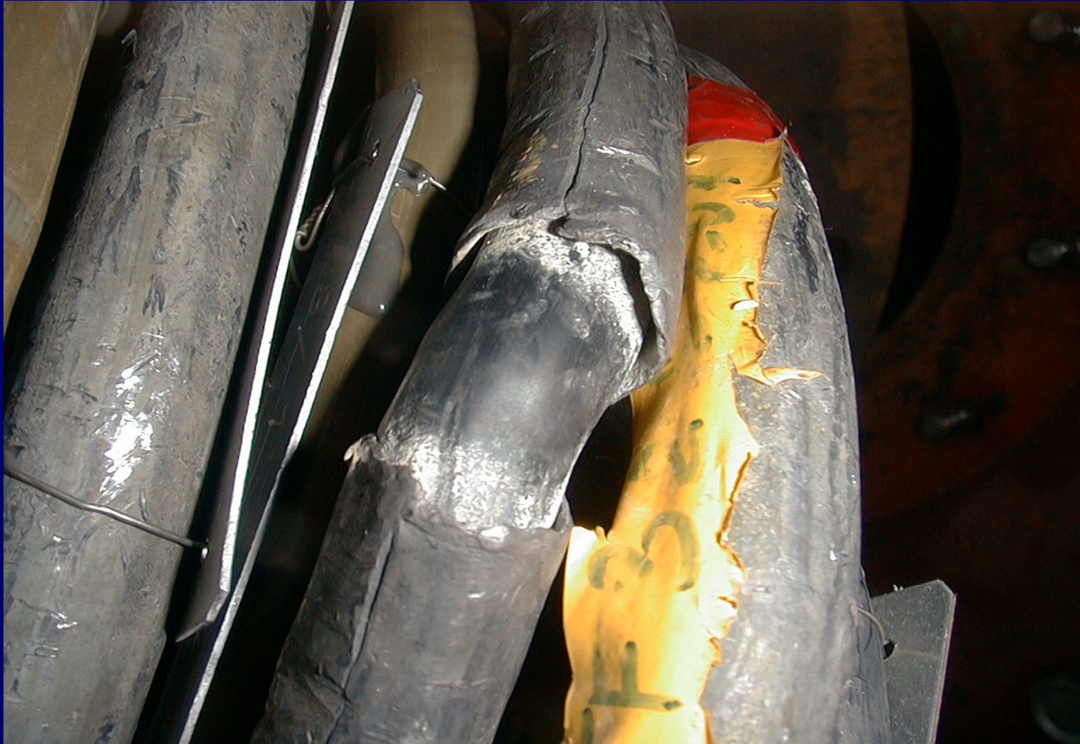
Sérült KPoSZG típusú kábel a vizsgálat végén
