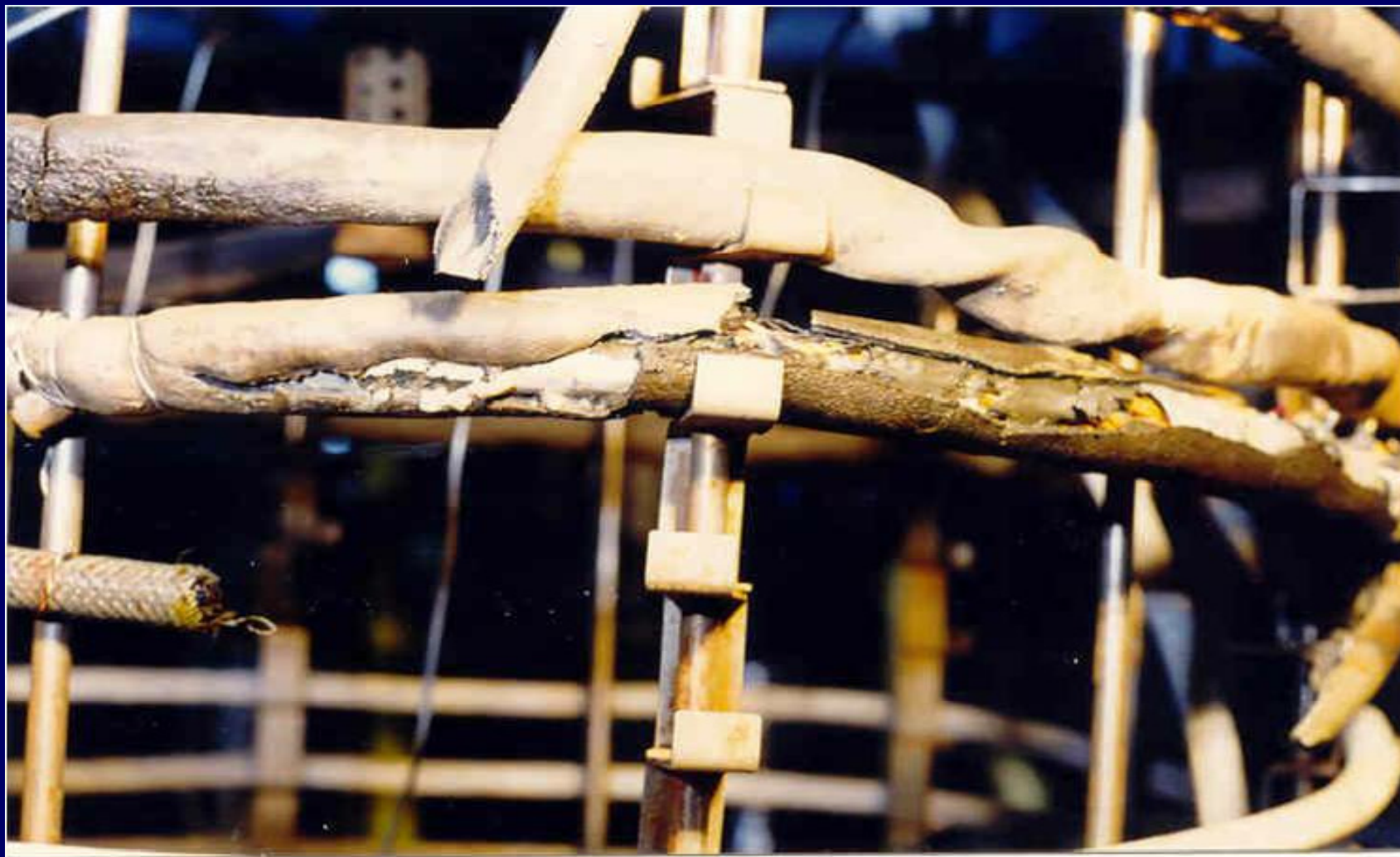
Sérült PVC kábelköpeny a vizsgálat végén
