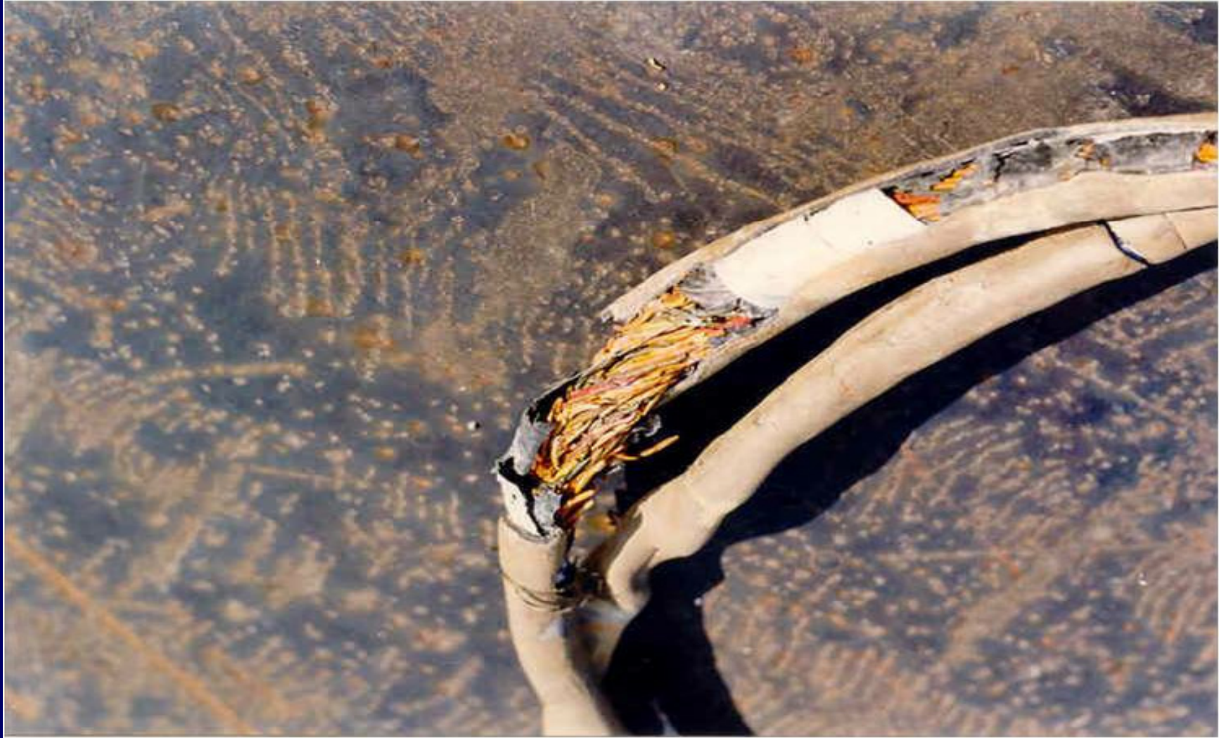
Meghibásodott PVC kábelszerkezet a vizsgálat végén
